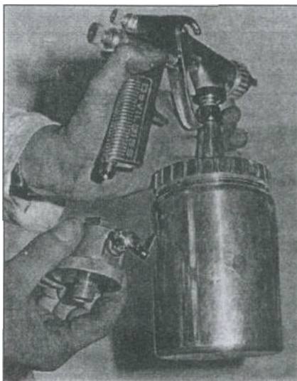
15.12 Установка влагоотделителя на ручку покрасочного пистолета
